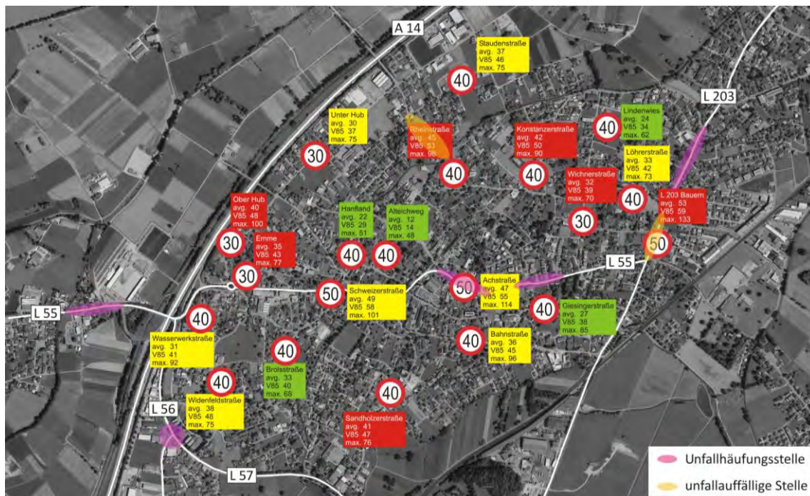
Abbildung A-0-14: Unfallhäufungsstellen und Geschwindigkeiten [3], [4], [8], eigene Bearbeitung
