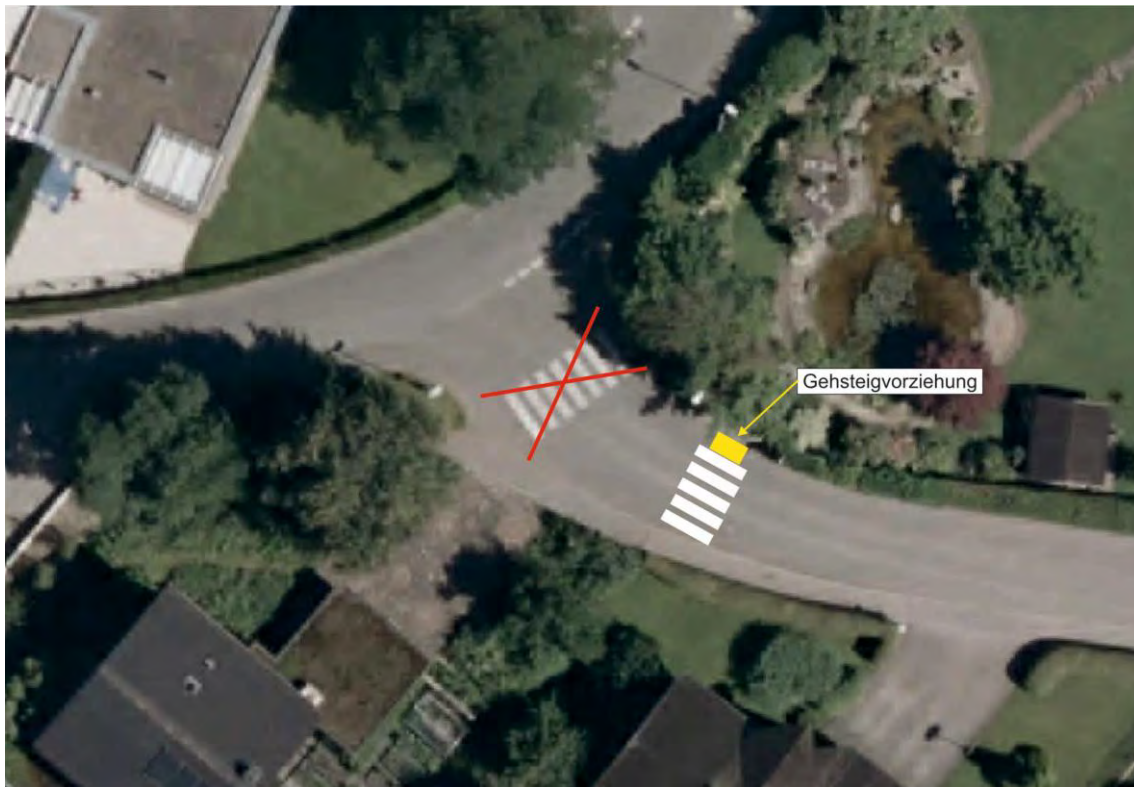
Abbildung 6-17: Verlegung Schutzweg Alte Kirchstraße [3]
